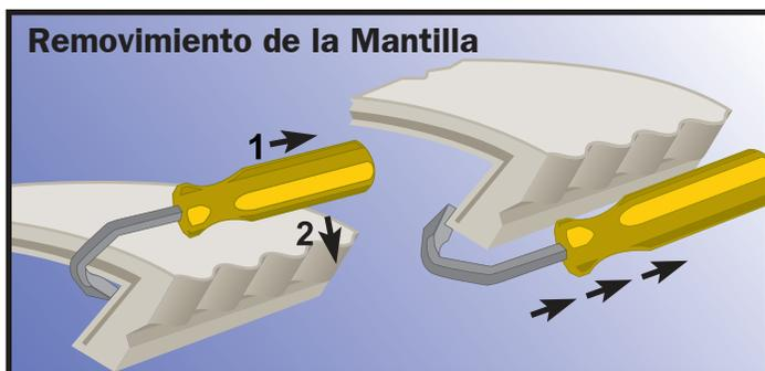
Posicione la navaja de la herramienta sobre la ranura entre la superficie del cilindro y debajo de la mantilla.
