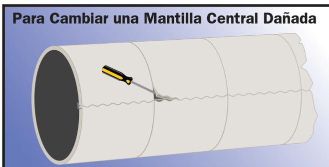
Utilice un desarmador de navaja delgada para levantar la orilla de la mantilla dañada hasta que esté libre del canal. Típicamente, después de este paso se puede jalar la mantilla. Si nó, utilice el desarmador para liberar el otro lado. Inserte la herramienta y córrala a través de la mantilla como en removimiento usual.
